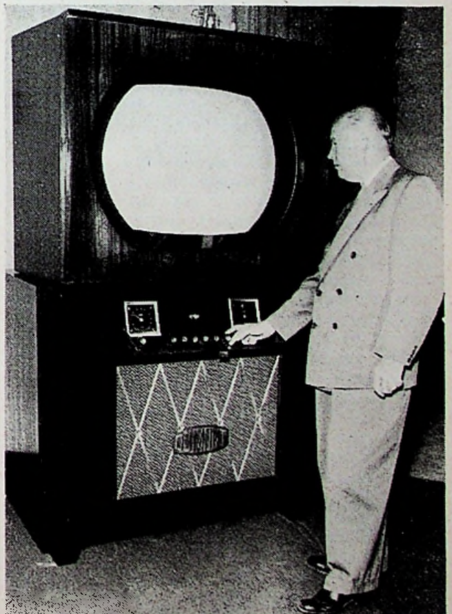
Bovenstaand toestel bevat de (voorlopig) grootste beeldbuis ter wereld, 75 cm. doormeter, gefabriceerd door Allen B. Dumont, die men zelf bij het toestel ziet. Dit buisformaat wordt thans bestudeerd als tegenhanger der TV-projectie.
